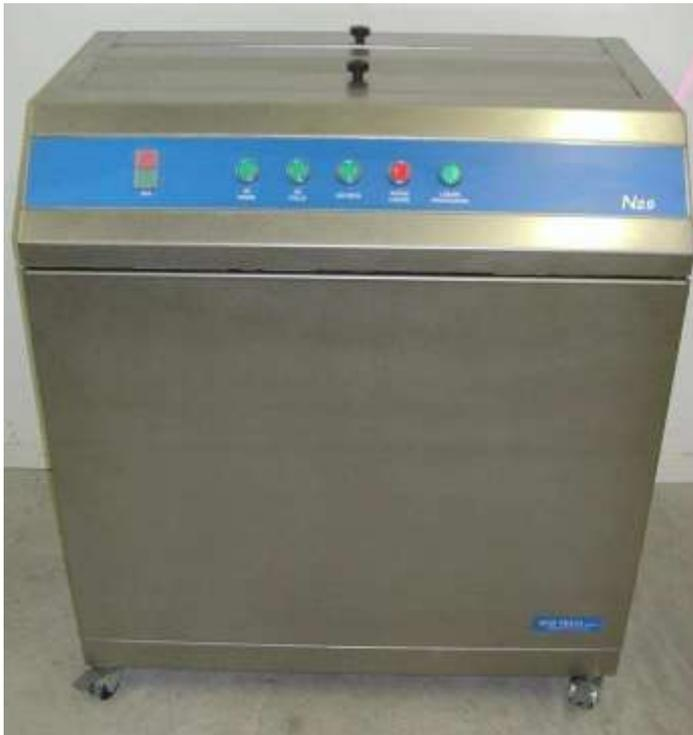
Spécialement conçue pour mettre en valeur le système MPC<sup>®</sup> (Micro Phase Cleaning) du Vigon SC200, le pochoir immergé verticalement, soumis à l'action d'ultrasons perpendiculaires, est parfaitement nettoyé en quelques minutes. Le sècheur indépendant permet de travailler en temps masqué.
